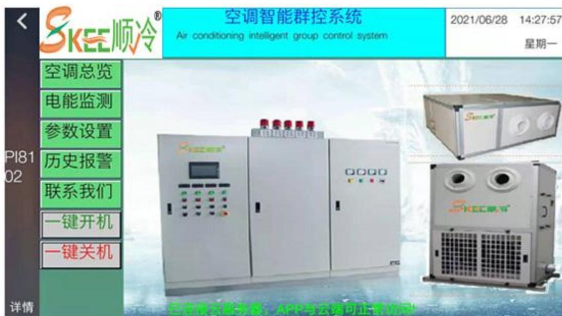
触摸屏上方为系统名称与走马灯报警信息（有报警时，走马灯形式显示当前报警信息），右上方为日期、时间与星期；中左上方有多个按钮，作为各画面功能跳转按钮与我司的联系方式，左下方为智能群控所有的空调开/关机按钮。
